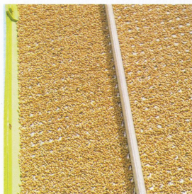
3D-rensverket fördelar materialet jämnt över sällytan
