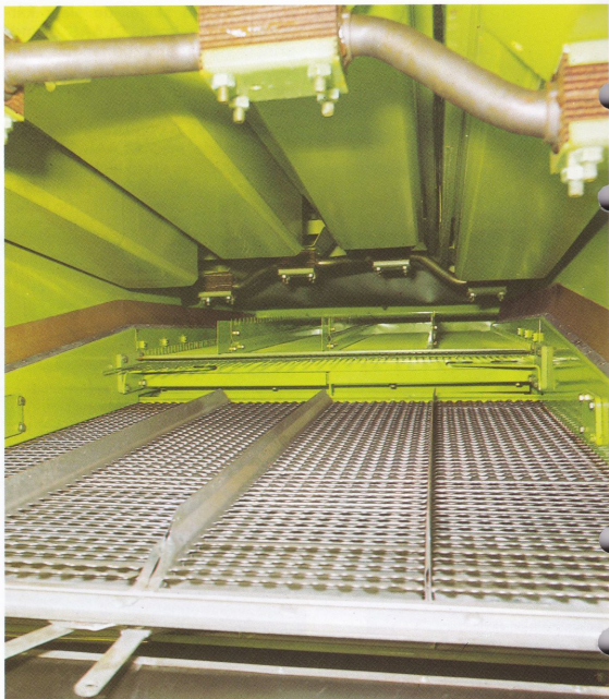
Stor sållyta. Ställbara lamellsåll. Spillindikator som känner av hela bredden på tröskverket, tillbehör
