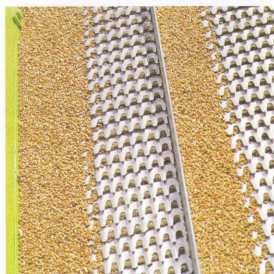
Utan 3D-rensverk samlas tröskgodset på ena sidan vid körning i sidolutningar 12
